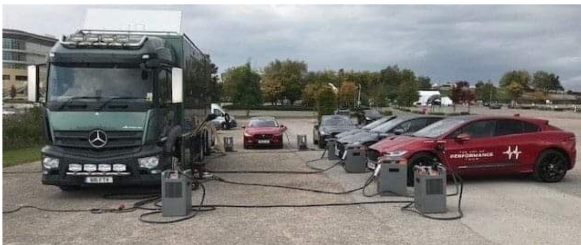
Figura 5.1. Camión diésel con generadores diésel a bordo, cargando coches eléctricos. Fuente: Mr Frank McVeety tweet
