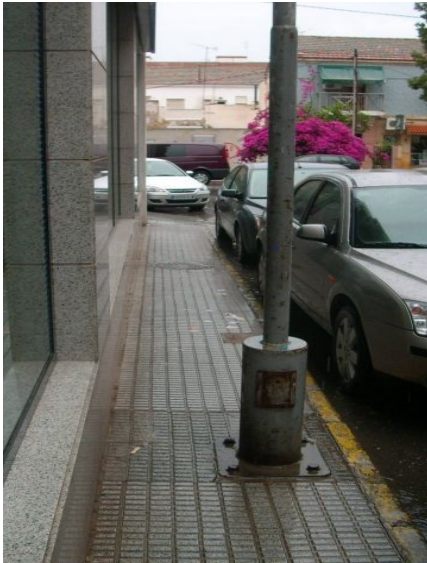
Figura 4.6. fotografía de acera de calle de barrio bastante común, sin apenas espacio para peatones, con mobiliario urbano (árboles con alcorques, farolas o señales de tráfico, etc.), que hace muy difícil o imposible la colocación de puntos de recarga en serie, para alimentar los coches que se estacionan por la noche en la calle.
