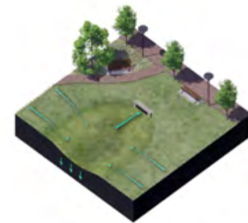
■ ■ ■ Dry Detention Pond
